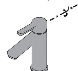
3 **Soltar el embellecedor** - Remove the cover - *Lâcher le cache écrou.*
