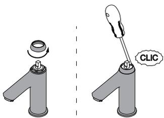
4 **Soltar la tuerca aprietacartuchos** - Remove the cartridge nut - *Lâcher l'écrou pour cartouche.*
