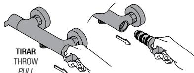
5 **Introducir el nuevo cartucho termostático** - Introduce the new thermostatic cartridge - *Introduire la nouvelle cartouche thermostatique.*
