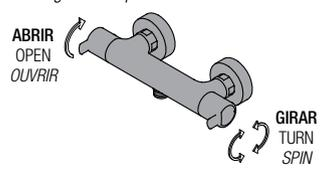
3 **Soltar el tornillo que sujeta el cartucho termostático con la llave allen** - Remove the screw that holds the thermostatic cartridge with the Allen key supplied - *Lâcher la vis qui fixe la cartouche thermostatique avec la clef allen fournie.*
