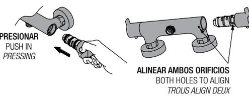
6 **Volver a introducir el tornillo con la llave allen y apretar hasta que el tornillo quede oculto en el grifo** - Install the screw with the Allen key supplied and tighten until the screw is hidden in the valve - *Introduire à nouveau la vis avec la clef allen et serrer jusqu'à que la vis reste occulte dans le robinet.*
