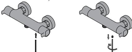
4 **Extraer el cartucho termostático tirando de la maneta** - Extract the thermostatic cartridge pulling the handle - *Extraire la cartouche thermostatique en tirant de la poignée.*
